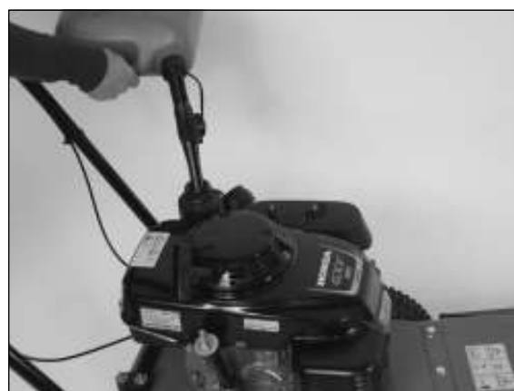
2) Houd de jerrycan zoals afgebeeld. Vul telkens maar een geringe hoeveelheid bij en controleer de vulhoogte.
