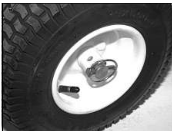
1. Keervrijloop inschakelen: steek de klapsplitpen alleen door de as.
