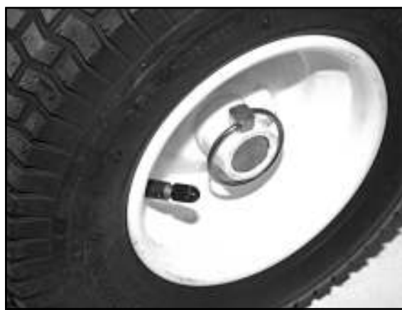
2) Keervrijloop uitschakelen: steek de klapsplitpen door as en naaf (bijv. bij het vegen op schuine oppervlakken)
